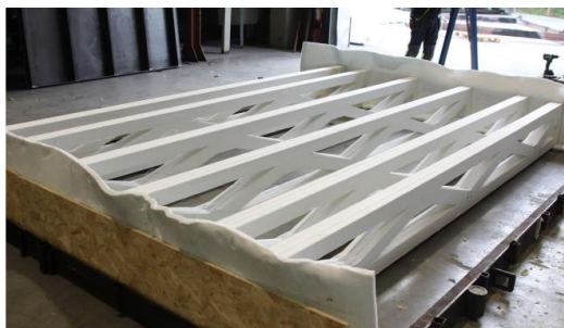
Fig. 1. Tredubbla fackverksbalkar innan brandtest
