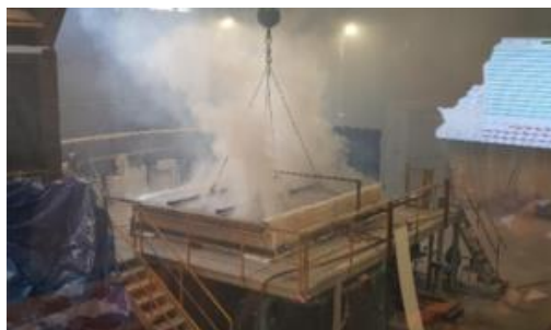
Fig. 2. Brandtest med tredubbla fackverksbalkar med vertikallast
